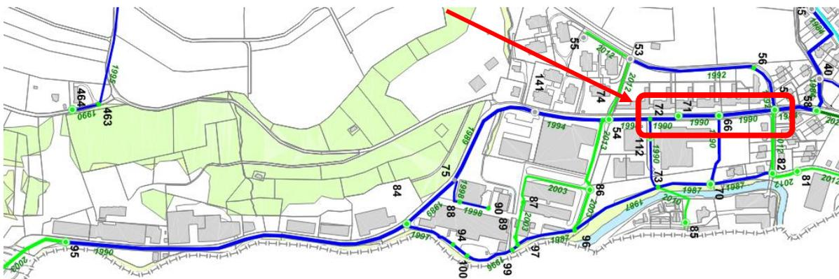
Während der Bauarbeiten wurde festgestellt, dass im Abschnitt zwischen der Wiesentalstrasse und der Industriestrasse 21, die 1980 verbauten «von Roll Ecopur» Rohre stark korrodiert sind und die Rohrbettung mit Aushubmaterial statt sauberem Leitungskies erfolgte, was zu örtlichem «Lochfrass» und einem entsprechenden Wasserleitungsbruch während den Bauarbeiten führte.
